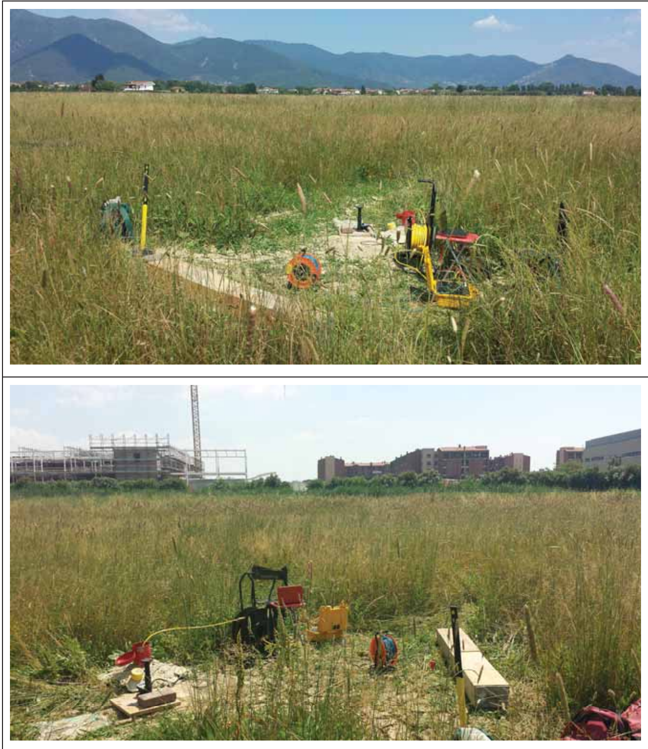
Fig. 4 – Sistema di energizzazione: mazza battente, piastra metallica e traversina in legno
