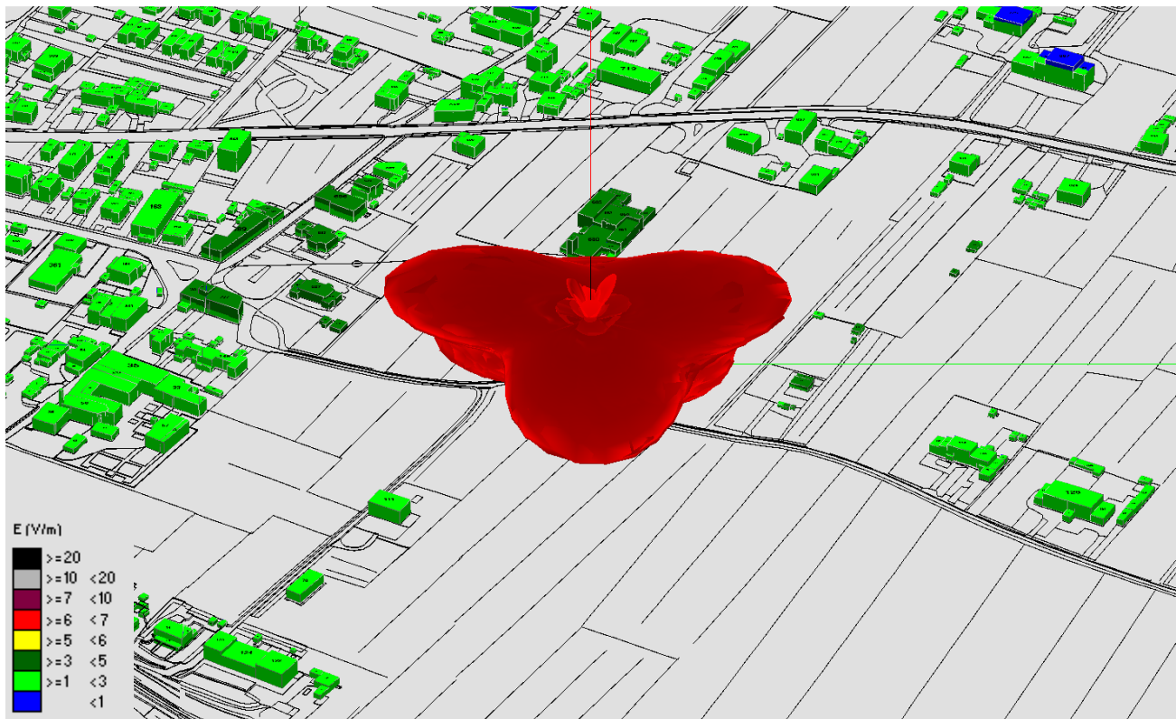
Fig. 2 Impatto Elettromagnetico – zona Via Traversagna – 0° N
