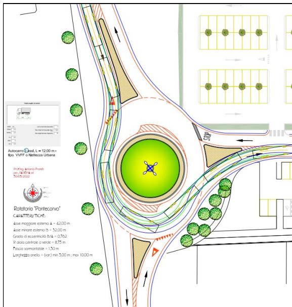
Autocarro 3 assi L=12,00 m: Verifica delle manovre di svolta da Via Pontecorvo Nord, prov. San Giuliano, nella Via Traversa P.C. e dalla Via Traversa P.C. in Via Pontecorvo Sud, dir. La Fontina.
