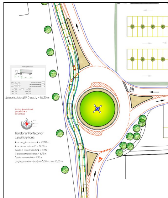
Autotreno ATP, L = 16,50 m: Verifica delle manovre di attraversamento della rotatoria lungo Via Pontecorvo: da Sud a Nord, e viceversa.
