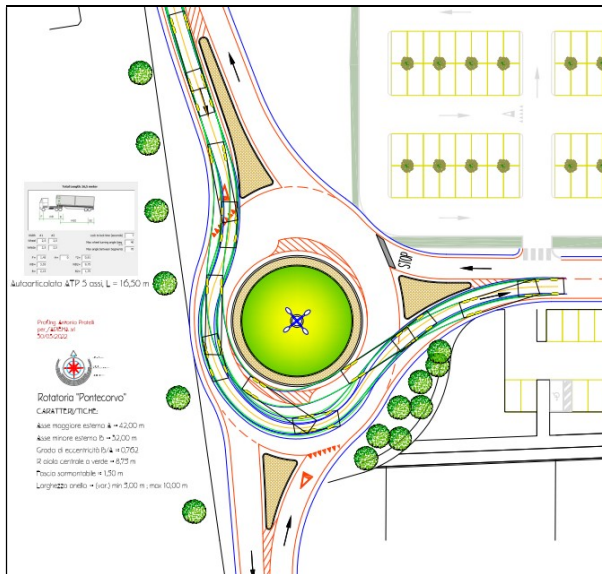
Autoarticolato ATP, L=16,50 m: Verifica delle manovre di svolta (sx) da Via Pontecorvo Nord in Via Traversa P.C. e da Via Traversa P.C. in Via Pontecorvo Sud (dir. Pisa - La Fontina).
