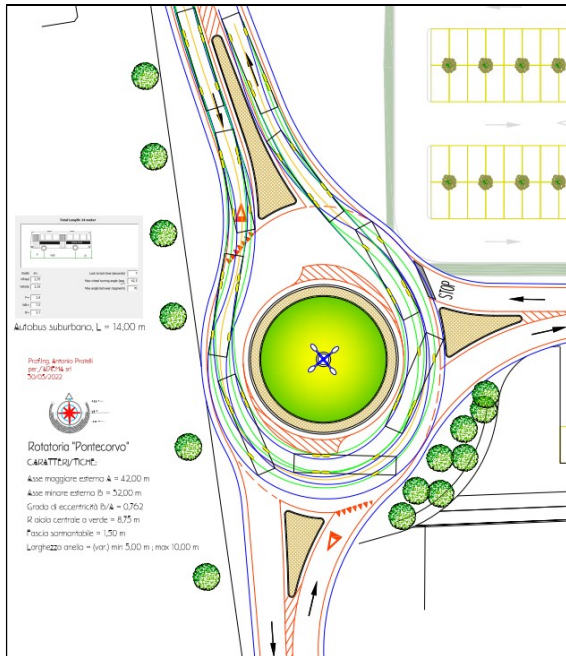
Autobus, L=14,00 m: Verifica delle manovre di inversione di marcia su Via Pontecorvo - dir. N/N (da/per San Giuliano T.me) e dir. S/S (da/per Pisa-La Fontina).
