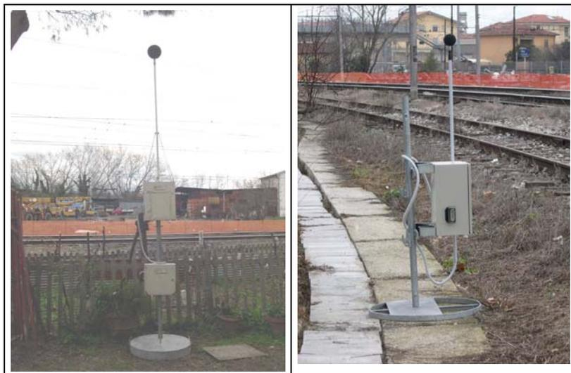
Figura 6.2: Foto delle centraline per esterno, a destra Tipo I e II, a sinistra Tipo III.
