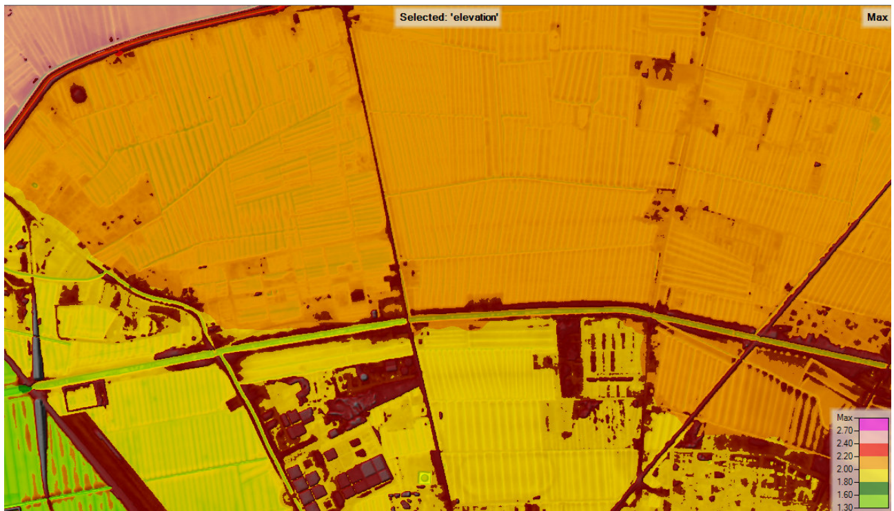
Figura 25 – Involuppo dei massimi delle superfici idriche per stato attuale simulazione Tr 200 anni
