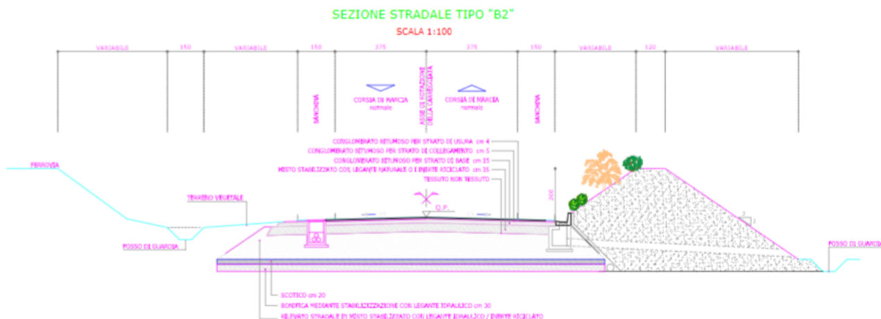
Figura 21 – Sezione tipo nel tratto tra i nodi 1 e 2 – Progetto Preliminare: terrapieno “tipo dune”
