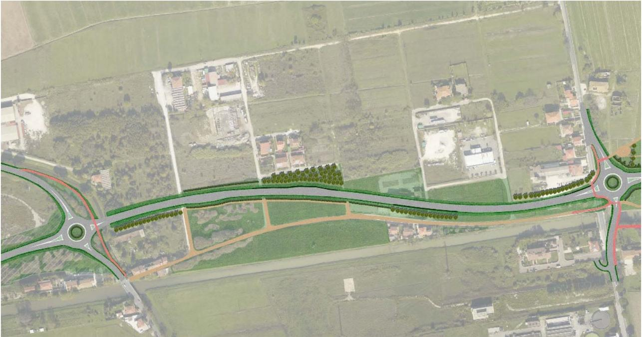
Figura 131 – Planimetria fotorealistica in corrispondenza dei nodi 3 e 4 (lotto 3-5) con tracciato dell'infrastruttura e mitigazioni previste
