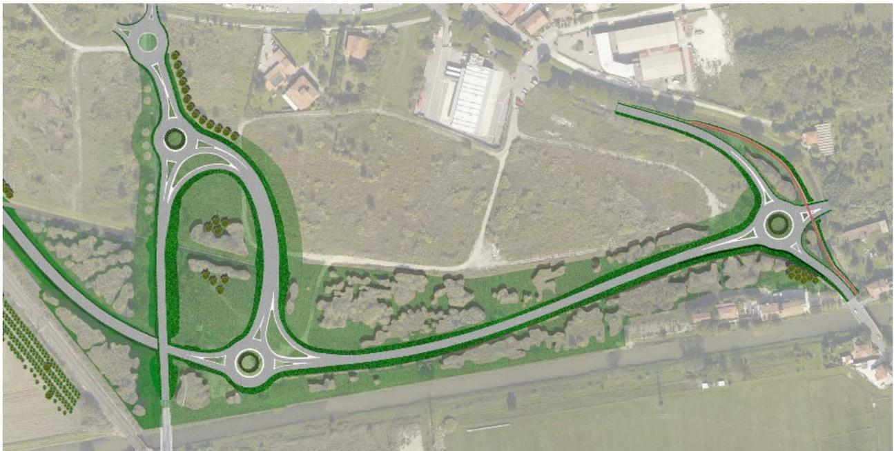
Figura 130 – Planimetria fotorealistica in corrispondenza dei nodi 2 e 3 (lotto 1-3) con tracciato dell'infrastruttura e mitigazioni previste
