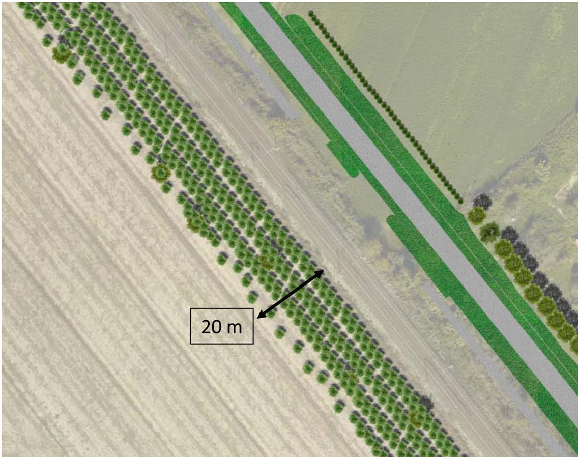
Figura 89 – Planimetria fotorealistica in corrispondenza del tratto 1-2 (lotto 1-2 stralcio) con tracciato dell’infrastruttura e mitigazione prevista (siepe di spessore 20 metri)
