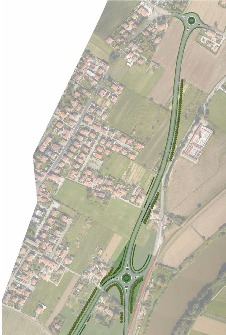
Figura 133 – Planimetria fotorealistica in corrispondenza del nodi 10 e 11 (lotto 10-12) con tracciato dell'infrastruttura e mitigazioni previste
