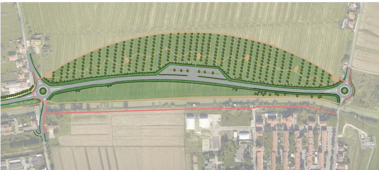
Figura 132 – Planimetria fotorealistica in corrispondenza dei nodi 4 e 5 (lotto 3-5) con tracciato dell'infrastruttura e mitigazioni previste
