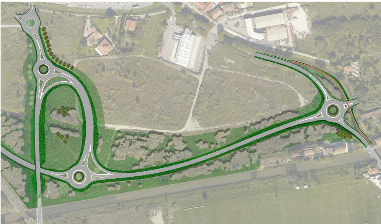
Figura 71 – Planimetria fotorealistica in corrispondenza del tratto 2-3 (lotto 3-5) con tracciato dell'infrastruttura e mitigazioni previste nei pressi del Fiume Morto
