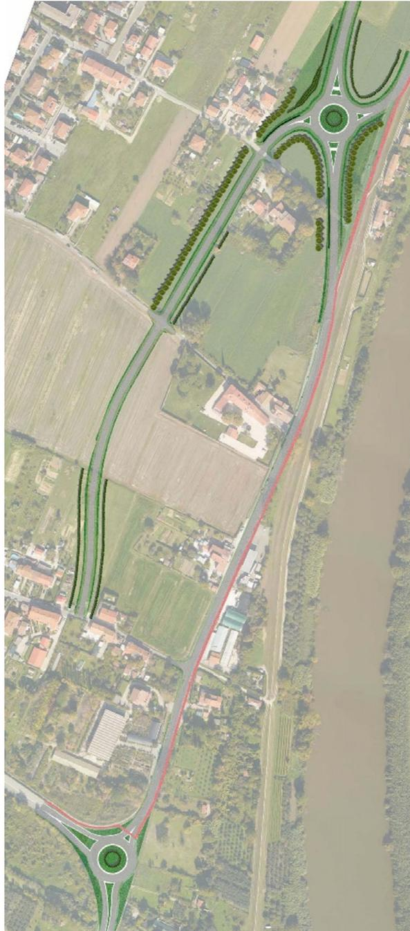
Figura 134 – Planimetria fotorealistica in corrispondenza dei nodi 11 e 12 (lotto 10-12) con tracciato dell'infrastruttura e mitigazioni previste
