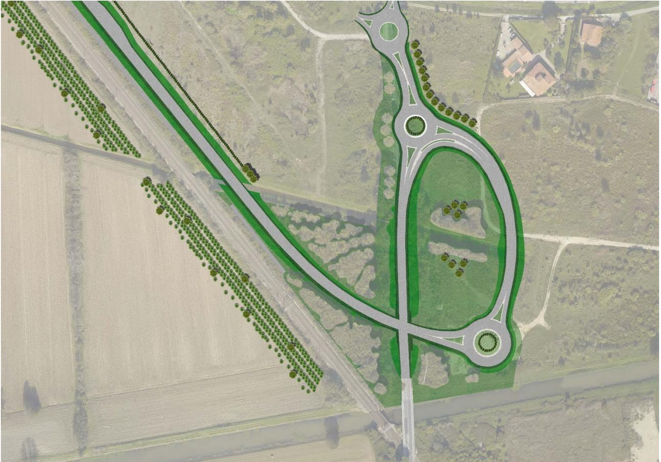
Figura 129 – Planimetria fotorealistica in corrispondenza del nodo 2 (lotto 1-2 stralcio) con tracciato dell'infrastruttura e mitigazioni previste
